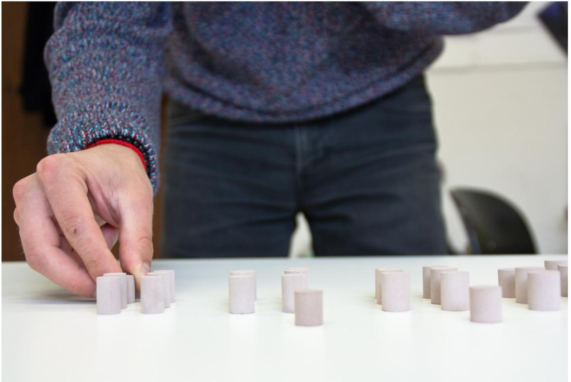
Am Ende entschieden wir uns für einen Durchmesser von circa 14mm für die Regler bei einer Höhe von 16mm. Die Form sollte simpel und somit zylindrisch sein, um die Regler an sich nicht allzu sehr in den Vordergrund zu rücken und das Interface zu überladen, was bei einer speziellen Formgebung und entsprechender Anzahl sehr schnell passieren könnte.
